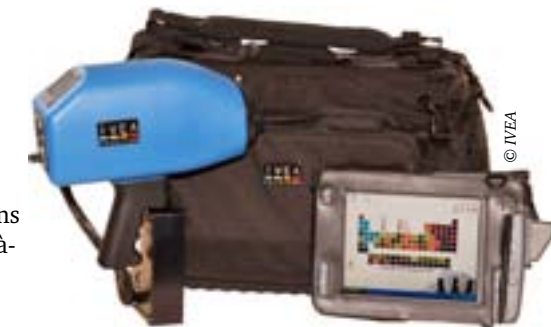
Appareil LIBS portable pour l'identification des déchets.
