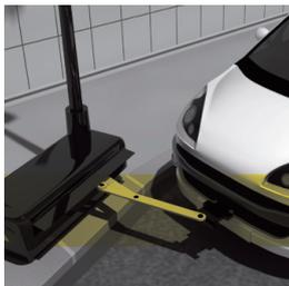
Le projet AMARE – Accrochage Mécanique Automatique à Rendez-vous Electronique – veut apporter une solution au développement urbain et périurbain des véhicules « décarbonés ». C'est un système de connexion intelligent d'un véhicule électrique à une borne de recharge automatisée et de couplage inter-véhicule. AMARE est adapté aux besoins de recharge fréquente, en toute sécurité. Il vise à valider :
