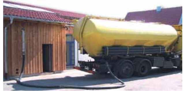
La livraison du granulé dans le silos de stockage se fait rapidement grâce à un camion souffleur.
