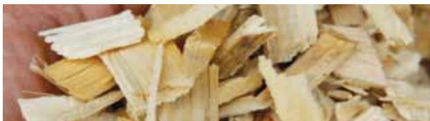
Les plaquettes sont utilisées dans les appareils à alimentation automatique.
