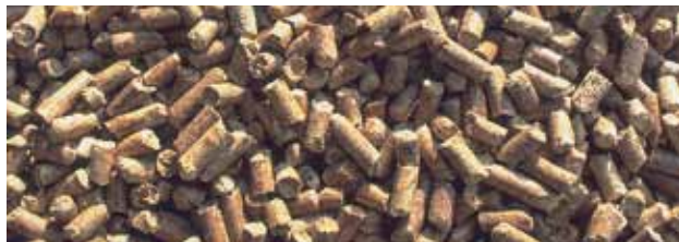
Les granulés sont utilisés dans des appareils à alimentation automatique. Ils permettent d'obtenir une autonomie de plusieurs jours (poêle) à 1 an (chaudière).
